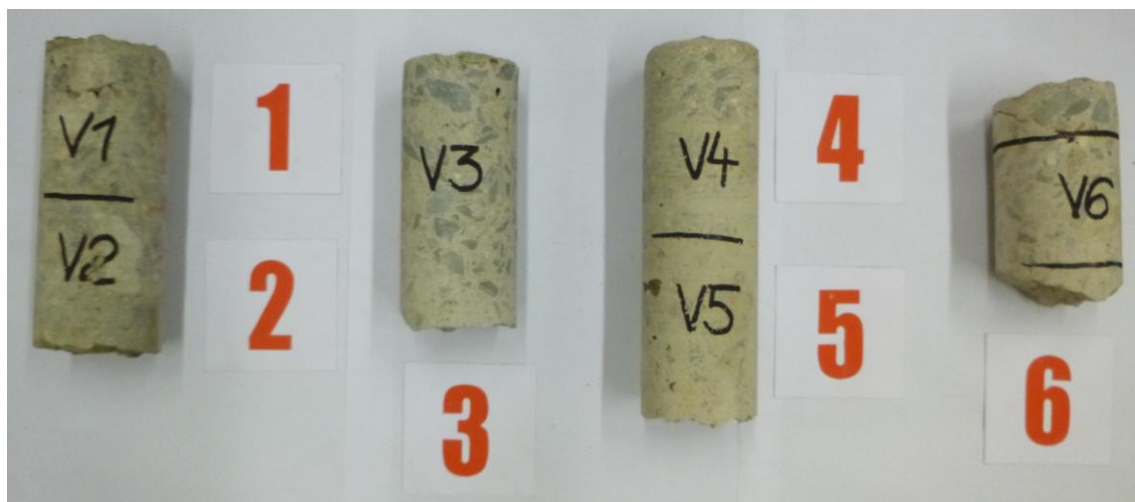
Obrázek č.1: Pevnost betonu v tlaku – dokumentace vzorků betonu
